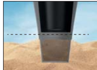
La base va empotrada en la arena
